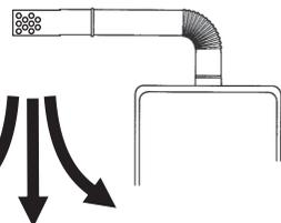
安裝時請勿將廢氣直接排放向熱水器入風口方向，以防燃燒時氧氣不足。
