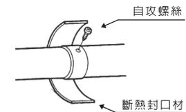
●排氣管必須在排氣管接續部或每隔90cm之長度,以懸吊配件加以固定之。請勿使用鋼絲線。
