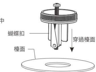
④ 確保蝴蝶扣扣進檯面底部，先從檯面上方鎖緊快速安裝座內螺栓，並套上止水墊圈。
