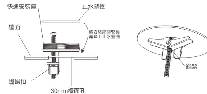
⑤ 龍頭管路從安裝座中穿過後，鎖緊安裝固定環，依照安裝示意圖將龍頭下方管線與訊號連接線連接至主機。
