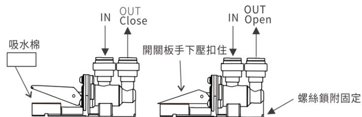
**⚠ 漏水斷路器功能:當廚下水路漏水時,吸水棉吸附到3~5ml膨脹,使開關彈起遮斷水路。**
