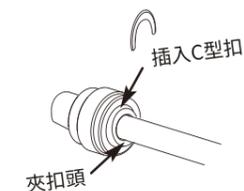
**⚠ 注意:請務必加裝C型扣,確保管路緊密,以降低漏水狀況發生。**
