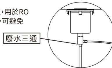
⚠ 若無法安裝廢水三通，請務必將廢水管固定確實，避免使用過程中脫落。
