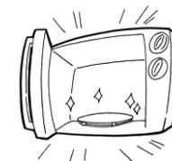
(8) 微波爐導波有側面導波和底部導波兩種方式。側面導波的微波爐產品腔體右側有波導口，請保持波導口的清潔，請不要把波導蓋（雲母片）取下，以免打火。
