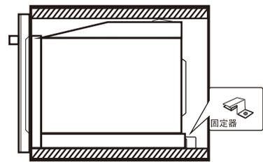
5. 打開爐門，用螺釘A將產品固定在廚具上。
