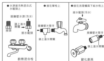
(注意：所有螺絲部分鎖緊時，請用止洩帶依順時鐘方向纏繞上 10-15 圈。)
