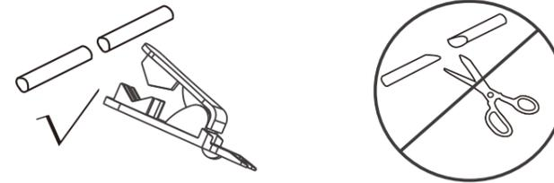
⚠ 裁剪水管時，請將水管管口剪平，切勿裁剪成斜切面。
