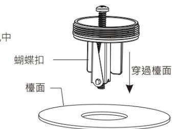
④ 確保蝴蝶扣扣進檯面底部，從檯面上方鎖緊安裝座內螺柱，並套上止水墊圈
