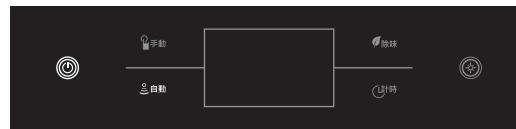
3.自動模式下，抽油煙機會根據溫度變化自動啟動並調節最適風量，並於顯示螢幕上顯示當下風量。不須另外手動操作。
