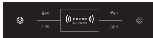
2.電源鍵及自動鍵恆亮，即為自動模式待機狀態，油煙機將24小時待機偵測，不須再手動操作或關閉電源。
