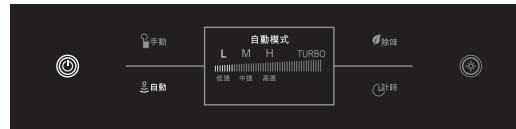
4.煮食結束後，油煙機將自動進入靜音除味模式(微速)20分鐘。圖示外圈圓弧表示計時20分鐘，每2分鐘遞減一格(呈現灰色)。
