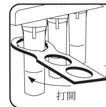
2. 取出已使用過的濾心，倒掉濾瓶中殘水，將拆掉包裝後的新濾心置入。
