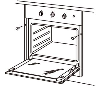
注意：請參閱上述的固定烤箱穩固方式，並絕緣電器元件，以避免接觸到金屬元件而導致受損。
