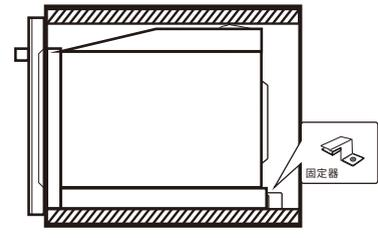
5. 打開爐門，用螺釘A將產品固定在廚具上。
