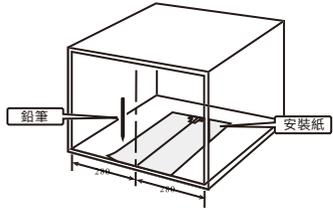
2. 取出安裝紙，在標記好的孔位上沾孔。然後將固定放置在標記位置上，用螺釘B固定。(打孔直徑：3mm)
